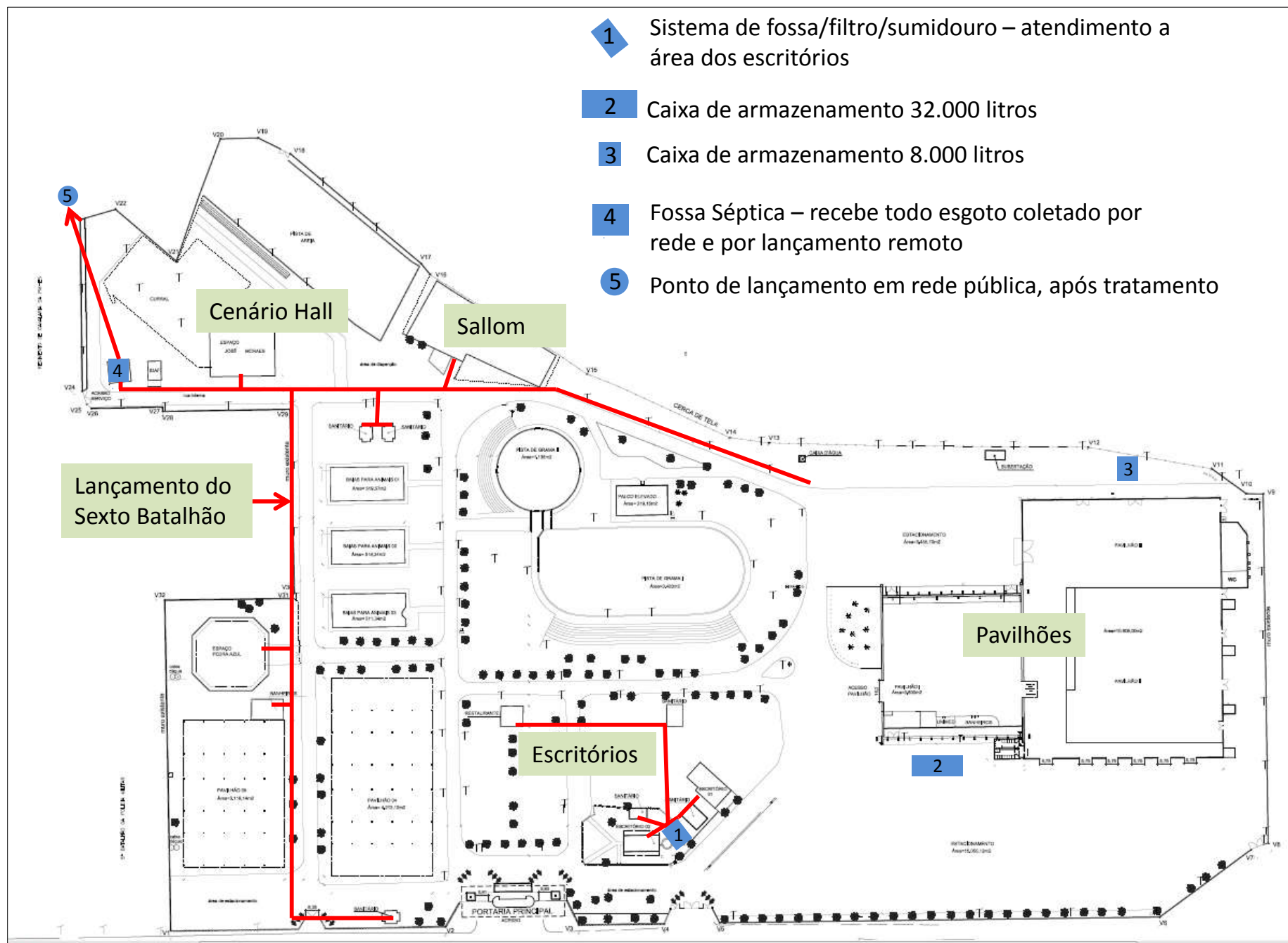
Figura 127: Esquema gráfico de sistema de coleta e tratamento de esgotamento sanitário do empreendimento.
